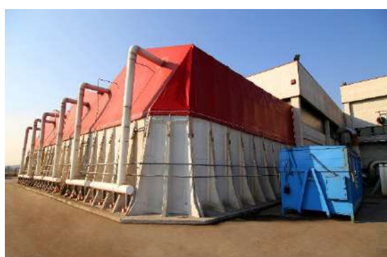
(4) BIOCELLE SCARABEO® PER MATURAZIONE DEL COMPOST
