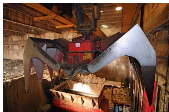
(1) CARROPONTE AUTOMATICO SPIDER® PER SPOSTARE IL MATERIALE
